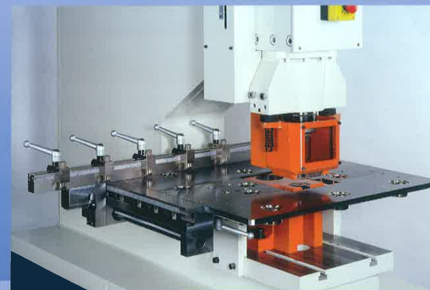
*Tables multi-stop (uniquement sur modèles S/SD/KD et PM)
