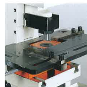
*Outil de poinçonnage au poste de grugeage
