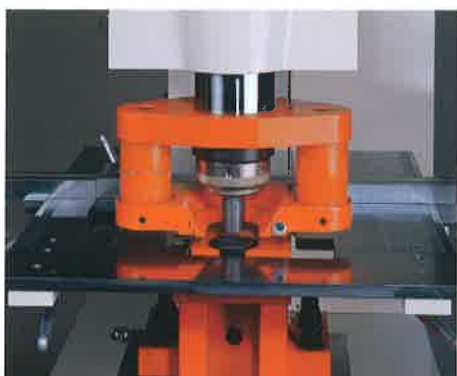
*Ressort dévêtissage en urethane pour déformation minimum
