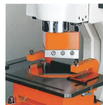
*Outil d'encoche à 90° (poste poinçonnage)
