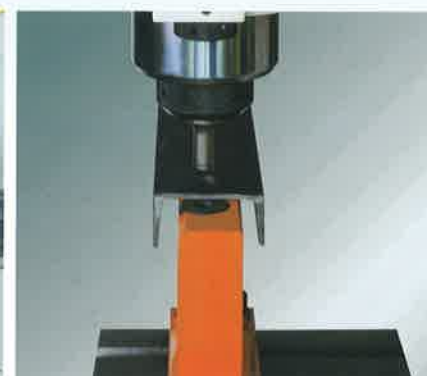
Porte-matrice à 1 trou pour poinçonnage UPN (en option sur les modèles à 2 vérins)
